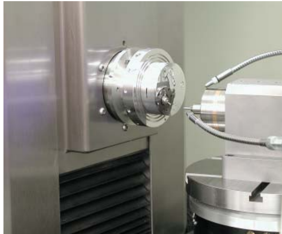
球面形状にミーリング加工
